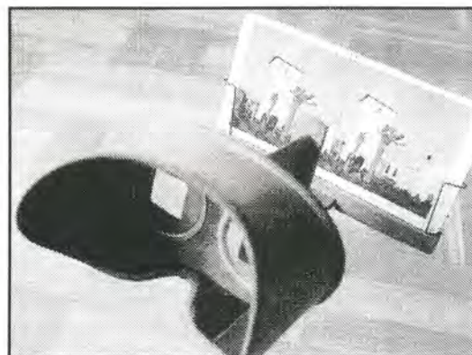
Stereoskopbilledet er optaget med digitalkamera. Et håndfremstillet vippestativ sørger for at optagelses punktet forskydes 65 mm.
